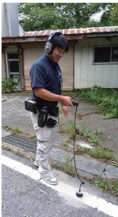
役場職員による漏水調査
